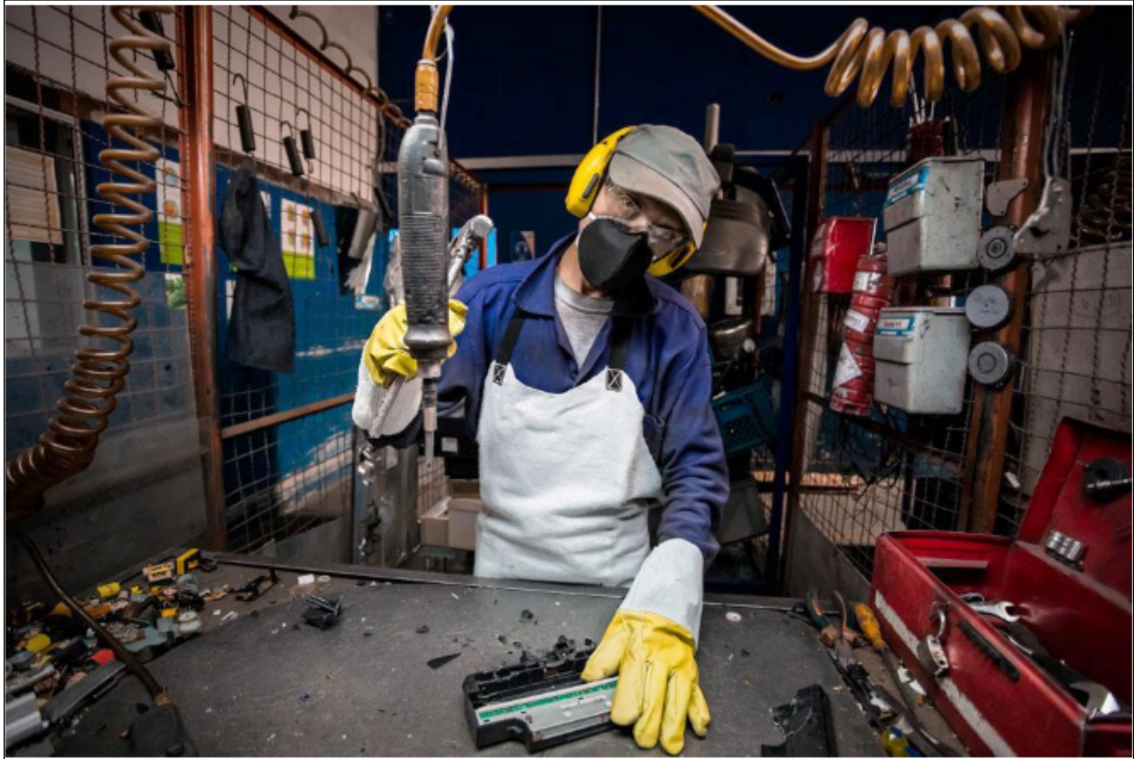
Gráfica 6. Proceso de desensamble y separación manual de los componentes RAEE
