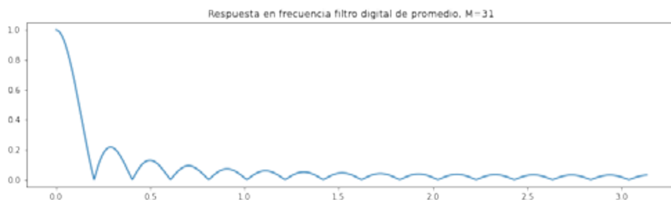
Figura 23. Magnitud de la respuesta en frecuencia de un filtro de promedio, M=31 .
