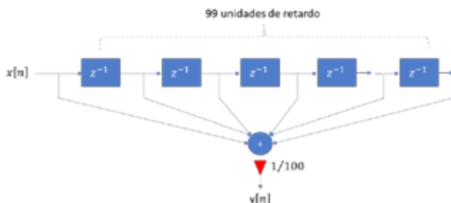
Figura 26. Diagrama de bloques filtro de promedio, M=100 .
