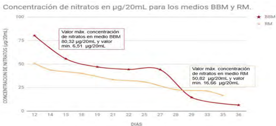
Figura 29. Concentración de nitratos en µg/20mL para los medios BBM y RM. Elaborada por los autores, 2019. (33)
