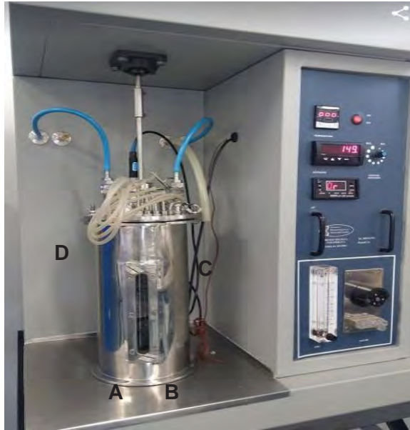
Figura 11. Fermentador Tecferm 5 litros. Fuente: Ángela Hernández, 2019. (31)
