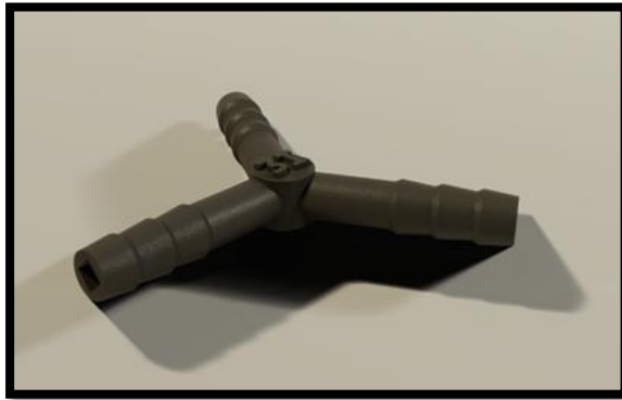
Figura 6. Modelo 3D de impresión del splitter .
