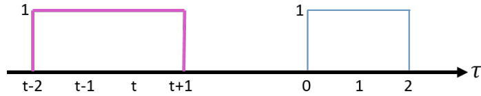
Figura 58. Paso 1: ejemplo de convolución en tiempo continuo.
