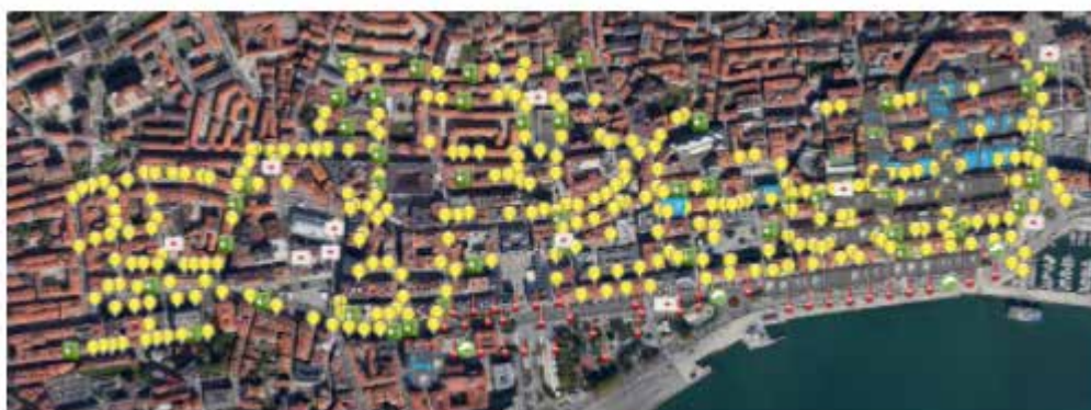
Figura 2. Arquitectura implementada de estacionamiento al aire libre.
